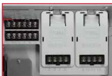
Конфигурация на 12 станций с модулями по (2) 4 станции
